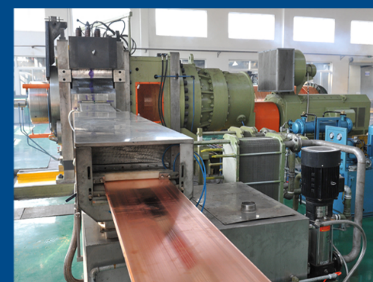
Линия по выпуску шин - Экструдер.
